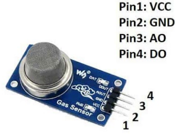
Şekil 3. MQ-2 Sensörüne ait pin yapısı (Xeohacker, 2024)
